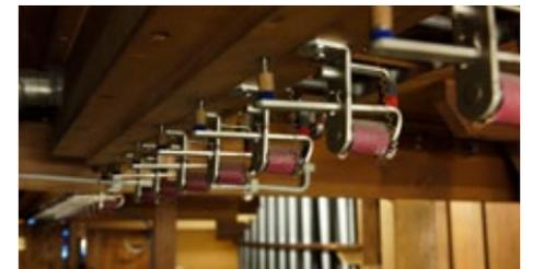
Die Magnetschalter (Foto oben) öffnen die Ventile in der Windlade (unten)
