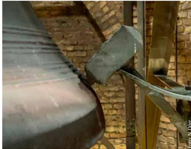
Für die „Zeitansage“ schlägt ein Hammer von außen die Viertelstunden- und einer die Stundenglocke an.
