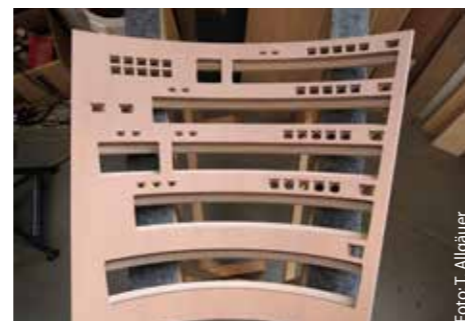
... und CNC-gesteuert aus Holz gefräst: Der Spieltisch der Auenorgel ist eine individuelle Maßanfertigung.
